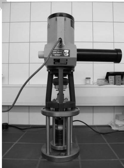
**Figure 4.** Haft- Zugmessgerät Type F20D Easy, Firma Josef Freundel Maschinen- u. Gerätebau.
